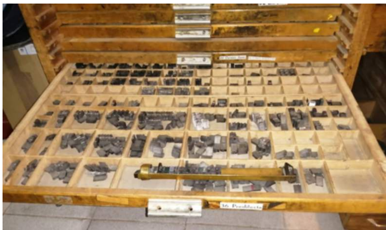
Caja con tipos de letra Predilecta y un componedor. Con útiles de esta especie fueron editados algunos de los impresos de la colección de Luisa Chaparro (2021)
